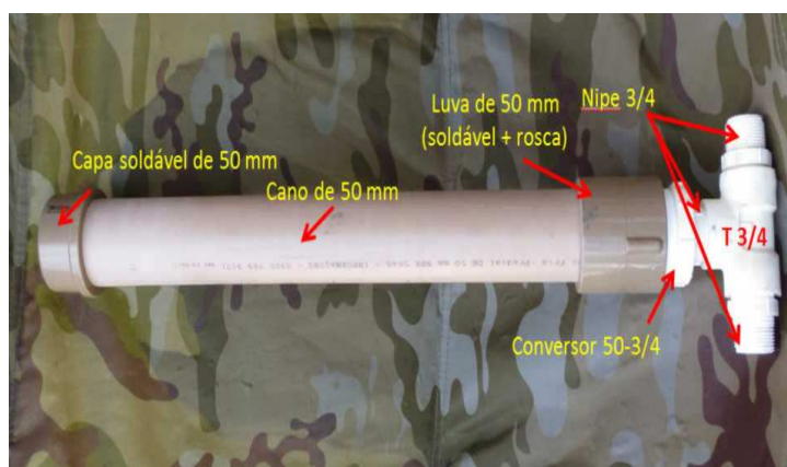
Acumulador de pressão caseiro
