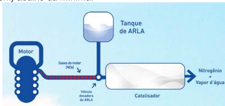
Funcionamento do catalisador com aditivo Arla32
