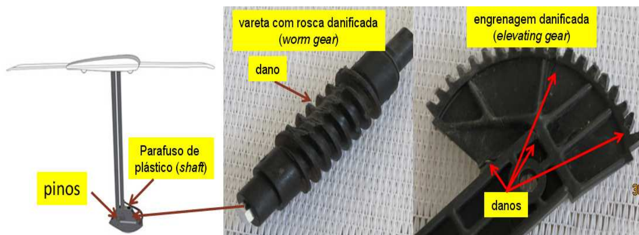
Antena winegard e engrenagens danificadas
