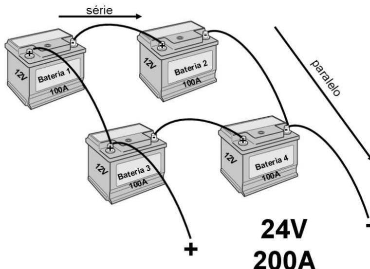
**Combinação de 4 baterias de 12V/100A:** cada duas formando um banco em série e os 2 bancos em série conectados em paralelo. O banco em série dobra a voltagem (12V → 24V) e o banco em paralelo dobra a amperagem (100 + 100 → 200A). O resultado é um banco de **24V / 200A**.
