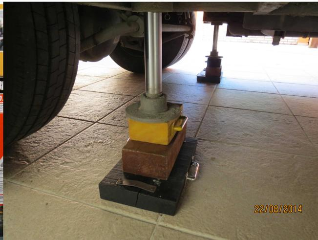
Calços para uso com sapatas. São 3 conjuntos para 3 sapatas (9 calços). Os calços abaixo dos amarelos (sem puxadores) são os maiores em área e que sempre estarão em contato com o solo. Use calços de madeiras resistentes: parajú, maçaranduba, ipê, peroba, faveiro, etc...
