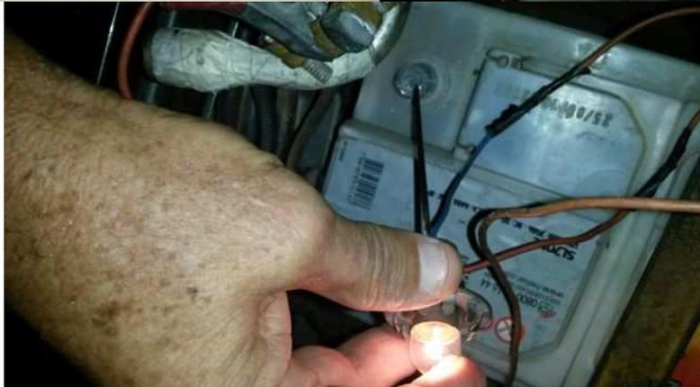
Teste (figura 1), teste conectado com lâmpada apagada (figura 2, não há fuga no sistema) e lâmpada acesa quando ligou-se as luzes do VR (registra corrente em fluxo para suprir as luzes)
