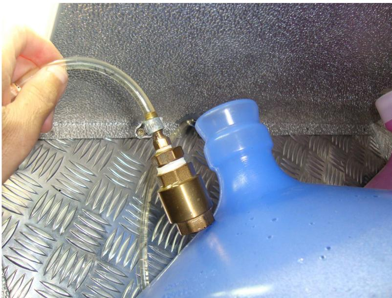
**Uso de válvula de retenção em bombona de água mineral para evitar retorno da bomba**
