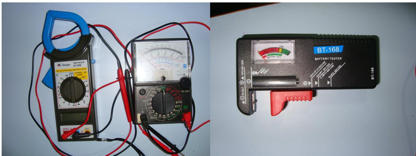
Da esquerda para a direita, amperímetro, multímetro e testador de pilhas
