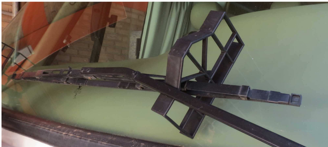
Limpador de para-brisa suspenso por alça de bateria
