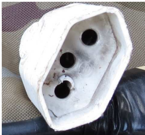
Tomada danificada por superaquecimento (mau contato)
