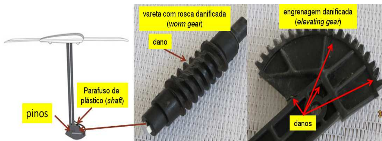
Antena winegard e engrenagens danificadas
