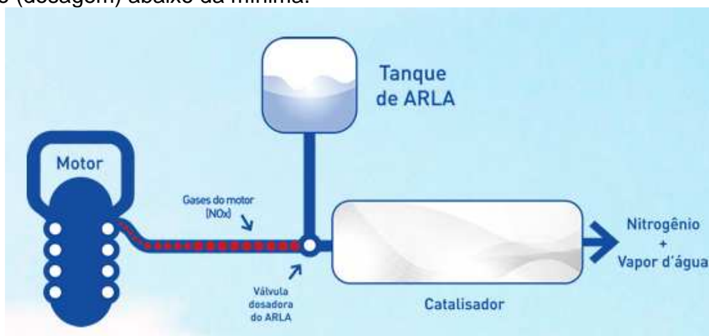
Funcionamento do catalisador com aditivo Arla32
