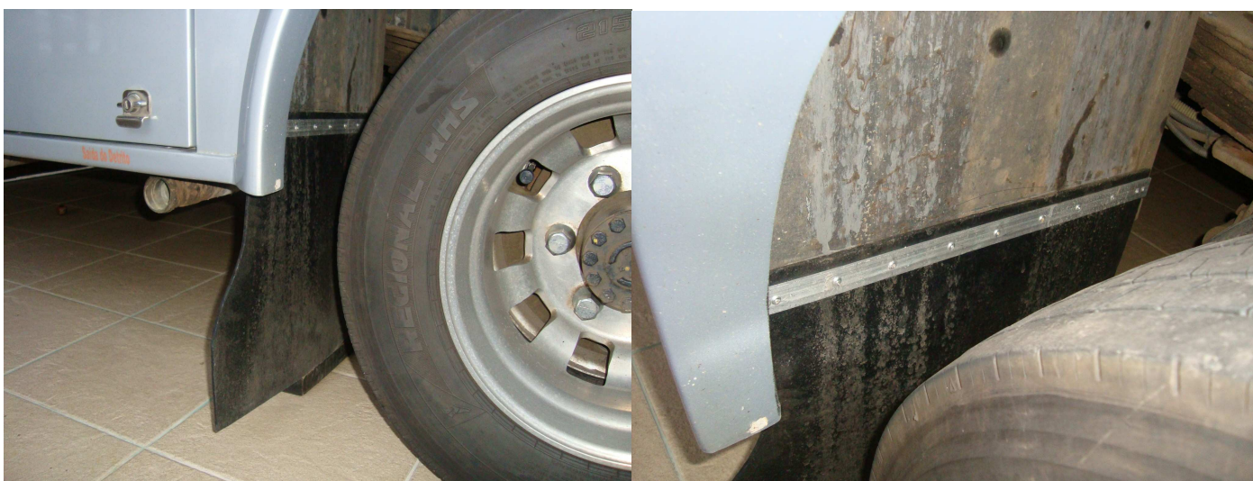
Parabarros instalados num VW-9.160 com barra de alumínio e rebites
